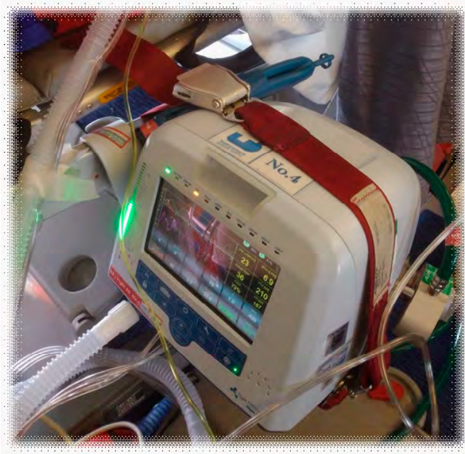
ภาพแสดงการยึดเครื่องช่วยหายใจกับเปลลำเลียงด้วยโครงโลหะ และผูกรัดเสริมความมั่นคง
